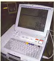
【心臓ペースメーカー】循環器科と併にペースメーカー植込み手術や交換手術、定期的な外来フォローアップまで一連の治療に関わります。(写真)ペースメーカー プログラマー
