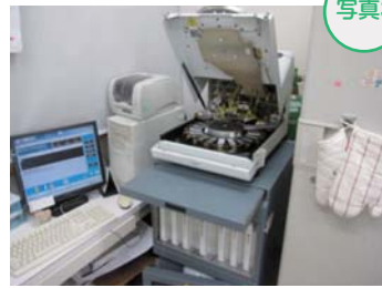
写真3 免疫染色装置（中央、左は操作パソコン）と超低温冷凍庫（右）
